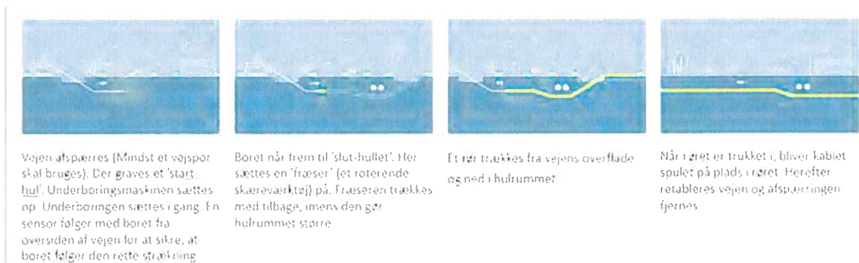
Figur 2 Principskitse for anlægsarbejdet
