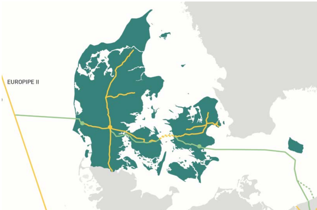
Figur 1 viser oversigt over Baltic Pipe (grøn signatur). Eksisterende gastransmissionsnet vist med gul signatur.
